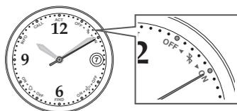
Es necesario intentar de nuevo el emparejamiento cuando la manecilla de los segundos señale «OFF» (posición de 5 segundos) de la indicación de estado de la conexión.
